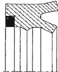
Primenjuje se za zaptivanje u teleskopskim cilindrima.
